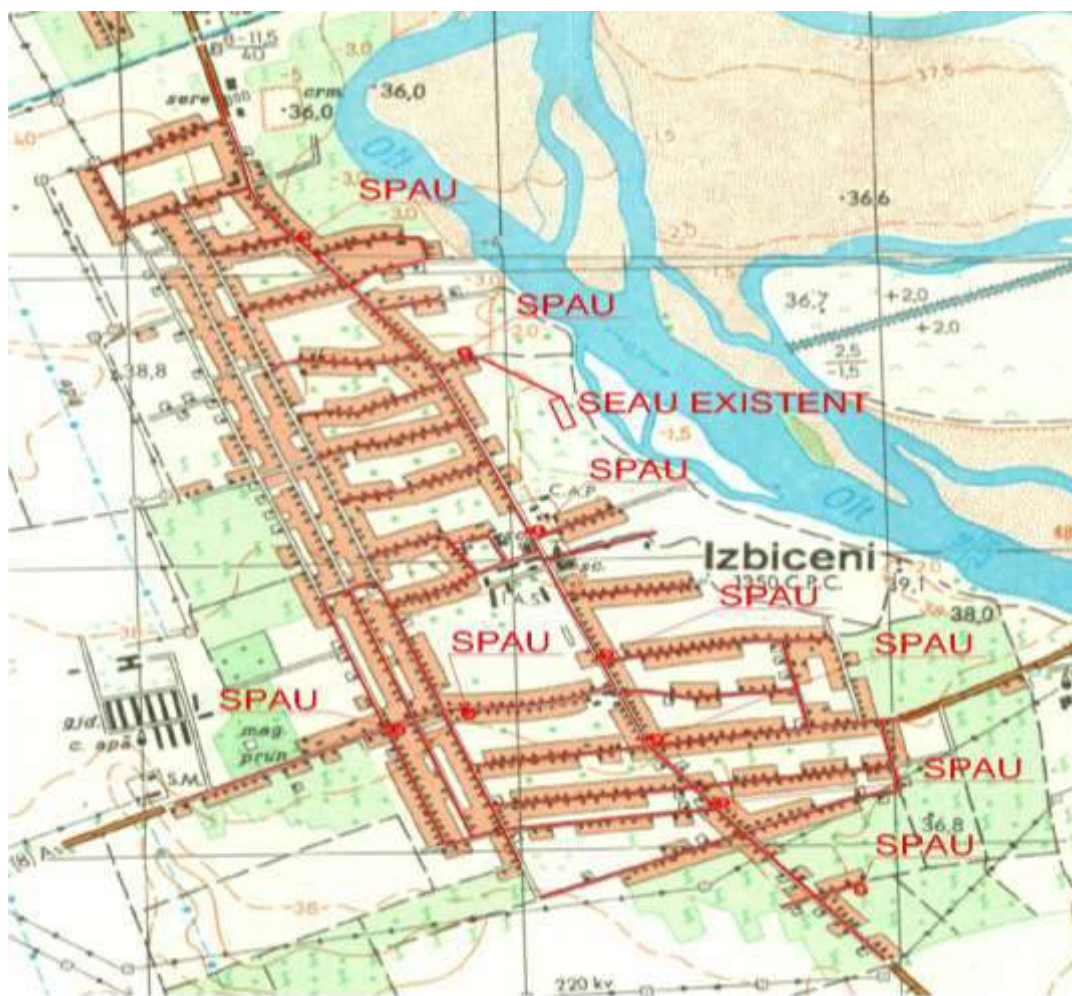
Figura Nr. 2 - 69 – Reteaua de canalizare Izbiceni
