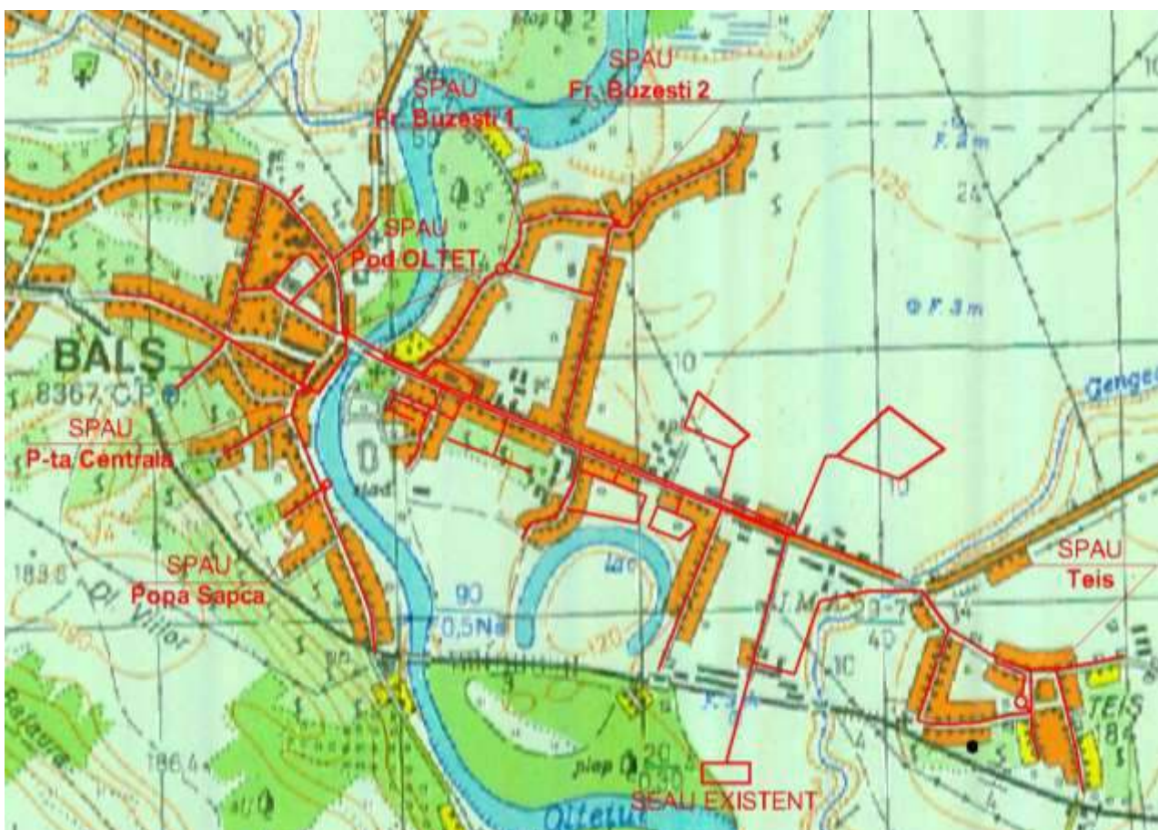
Figura Nr. 2 - 68 – Reteaua de canalizare Bals
