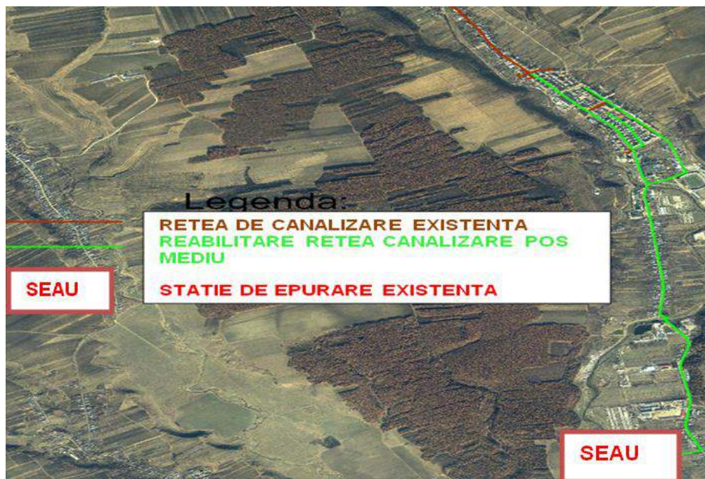
Figura 30 - Descrierea infrastructurii Aglomerare Scornicești (Existenț-POS Mediu)
