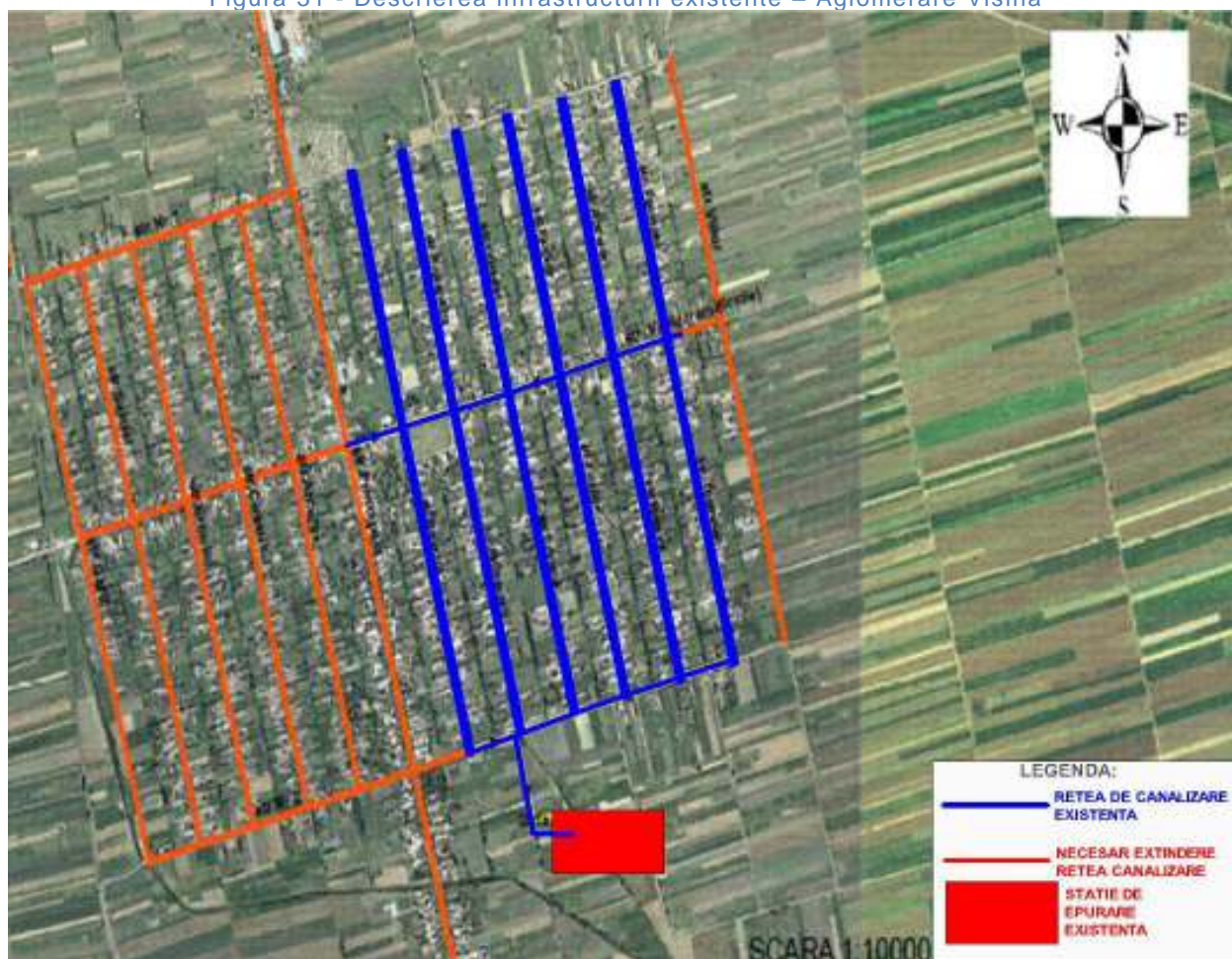
Figura 31 - Descrierea infrastructurii existente – Aglomerare Vișina
